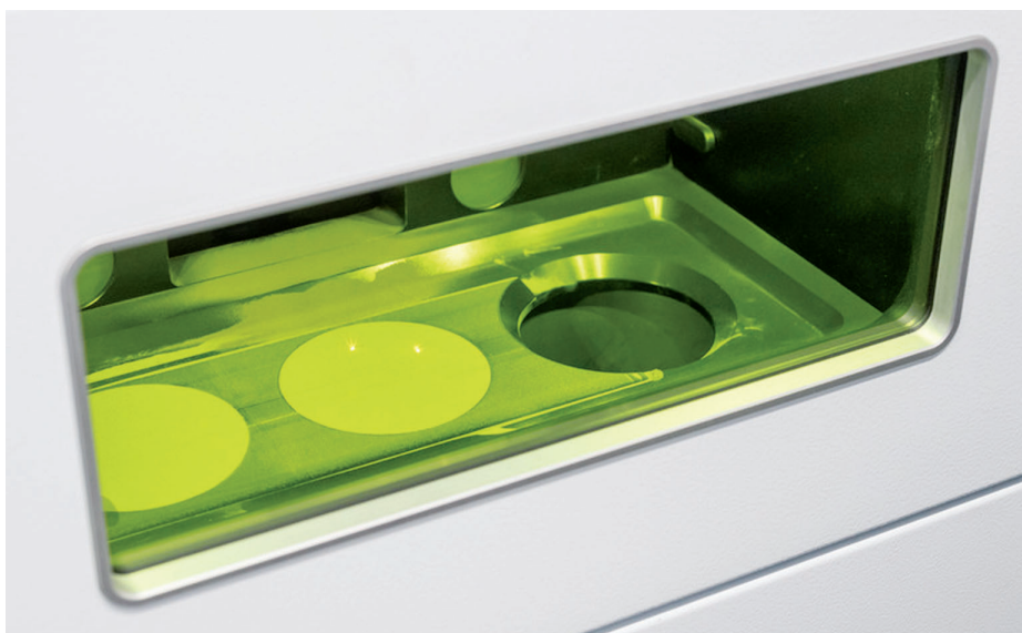
▲ LMF mit TruPrint 1000: Ein Laser schmilzt die Geometrie der Implantate passgenau aus dem Pulverbett heraus.
