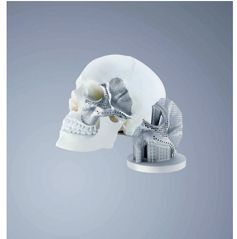
▲ Conmet erstellt mit dem Trumpf 3D-Drucker TruPrint 1000 maßgeschneiderte Gesichtsimplantate.
