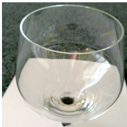
▲ Abb. 3: Glas nach Absprengung der Blaskappe mit CO 2 -Kurzpuls laser MICROSTORM™.
